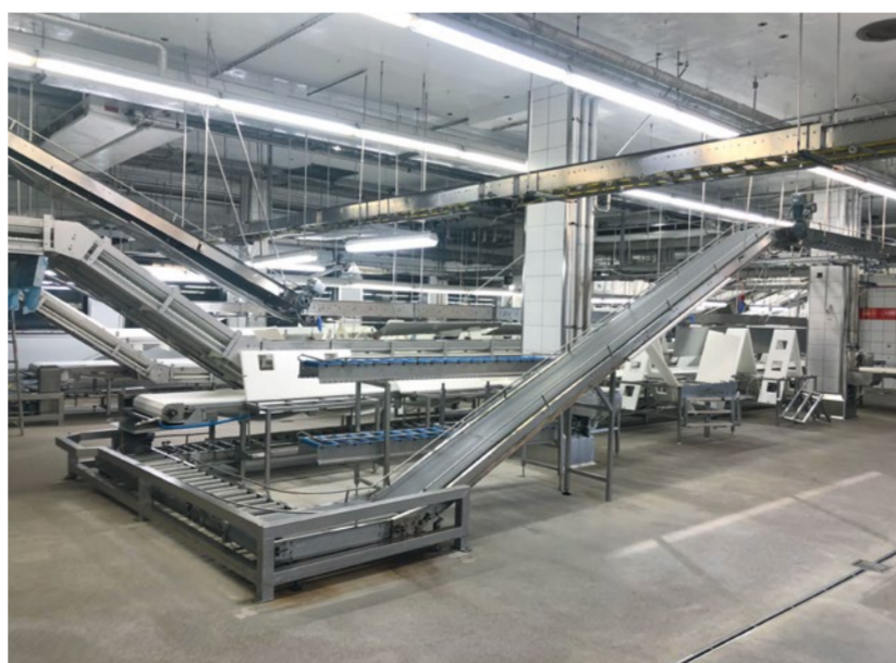
Rinderschlachtung mit 2 Betäubungsboxen, Ausschalllinie für 140 Rinder pro Stunde und Frischfleischzerlegung.
